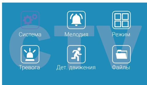
Главное меню состоит из разделов «Система», «Мелодия», «Режим», «Тревога», «Дет. движения» и «Файлы». Для выбора раздела вращайте кнопку-колесо, а для входа в нужный раздел нажмите на нее. Внутри раздела выбирайте нужный параметр нажатием на кнопку-колесо, изменяйте значения вращением колеса и фиксируйте выбранное значение нажатием на кнопку «Фото».
