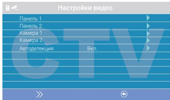
Параметры «Панель 1», «Панель 2», «Камера 1» и «Камера 2» используются для указания стандарта, разрешения и формата видеосигнала по выбранному каналу вручную. Выберите нужный канал и нажмите кнопку «Меню», откроется окно:
