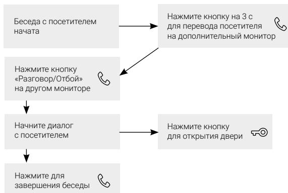
После переадресации вызова на другой монитор первый монитор перейдет в режим ожидания.
